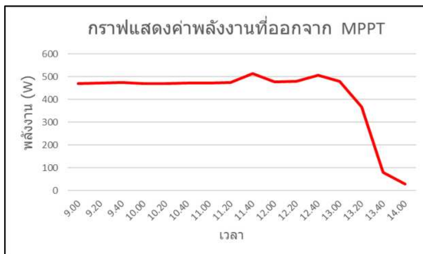
กราฟที่ 2 แสดงค่าพลังงานที่ออกจากกล่องคอนโทรลชาร์จเจอร์ (MPPT) ผลการทดสอบการทำงานของแผง Solar Cell ขนาด 1100 วัตต์ จ่ายเข้าแบตเตอรี่ 72 โวลต์ 20 แอมป์ 1 ก้อน
