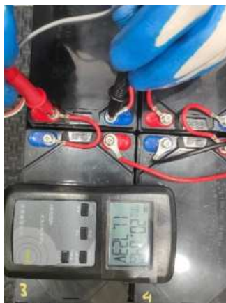
ภาพ 4.1 การวัดความต้านทานแบตเตอรี่ใช้เครื่องมือ IR Battery
