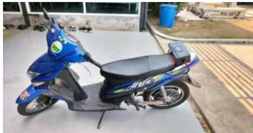
ภาพ.2 รถจักรยานยนต์ไฟฟ้า 2,000 วัตต์ แบตเตอรี่ 72 โวลต์ 20 แอมป์
