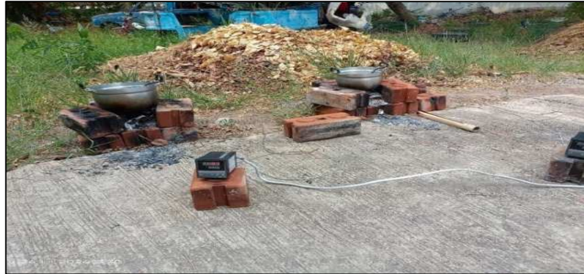
รูปที่ 4 การทดลองใช้ถ่านที่ได้จากเตาเผาถ่าน ด้วยวิธีการต้มน้ำ (Water Boiling Test) [8]
