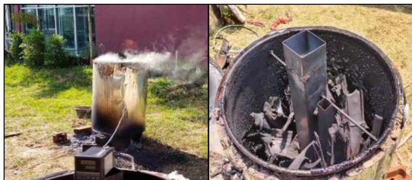
รูปที่ 3 การทดลองเผาถ่านด้วยเตาเผาถ่านแบบใช้ฉนวนกันความร้อนเซรามิกไฟเบอร์
