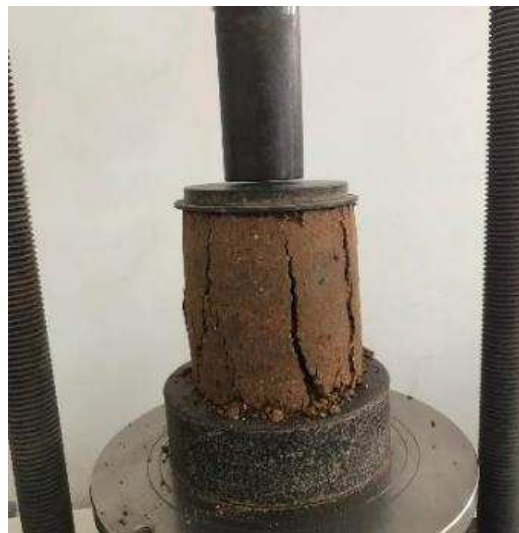
ภาพที่ 3 การบีบอัดของก้อนตัวอย่างของดินลูกรังที่ผสมกากแคลเซียมคาร์ไบด์
