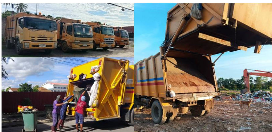
ภาพที่ 1 รถบรรทุกขยะแบบอัดท้าย ขนาด 6,000 กิโลกรัม
