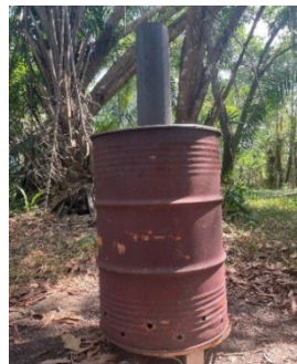
ภาพที่ 2 อุปกรณ์สำหรับเผาไบโอชาร์ (ก) อุปกรณ์สำหรับเผาไบโอชาร์จริง
