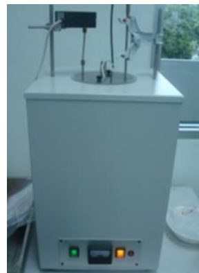
รูปที่ 3 เครื่องบอมป์แคลอรีมิเตอร์ รุ่น Art.2060/2070
