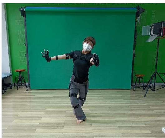
รูปที่ 3 การตรวจจับการเคลื่อนไหวด้านนาฏศิลป์ด้วยชุดอุปกรณ์เชิงแม่เหล็กไฟฟ้าแบบวัดค่าความเฉื่อย
