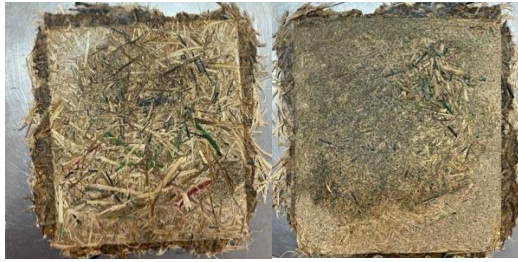
รูปที่ 3 แสดงแผ่นตัวอย่างวัสดุชีวภาพจากเศษเส้นกกเพื่อเตรียมขึ้นกล่อง
