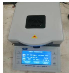
รูปที่ 3 การอบหาความชื้นแบบฮาโลเจน
