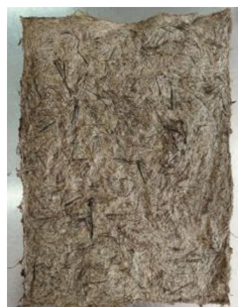
รูปที่ 3 แผ่นดูดซับเสียงจากเยื่อกกที่เตรียมด้วย NaOH ความเข้มข้นร้อยละ 15 โดยน้ำหนักของเศษเสื่อกกแห้ง มีความหนา 25 มิลลิเมตร
