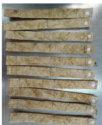
รูปที่ 4 ชิ้นงานทดสอบความต้านทานแรงดึงจากแผ่นดูดซับเสียงจากเยือก
