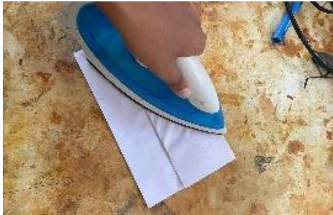
รูปที่ 13 การรีดแผ่นวงจรพิมพ์ด้วยเตารีด
