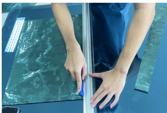
รูปที่ 5 การตัดแผ่นพรีเพรกให้มีขนาด 5 \times 50 \text{ cm}^2
