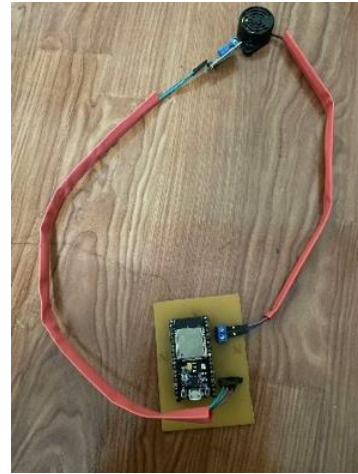
รูปที่ 27 การติดตั้งระบบกันขโมยอัจฉริยะ
