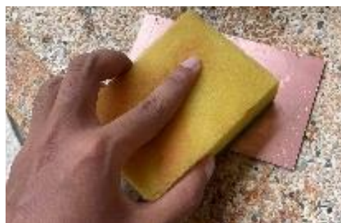
รูปที่ 12 การขัดผิวแผ่นทองแดง
