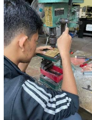
รูปที่ 16 การเจาะรูบนแผ่นวงจรพิมพ์
