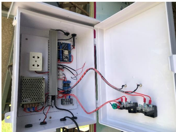
รูปที่ 1 แผงควบคุมพร้อมระบบเฝ้าสังเกตข้อมูลและควบคุมการรดน้ำผ่านอินเทอร์เน็ต ที่มา: ธงชัย เจือจันทร์ และคณะ [13]
