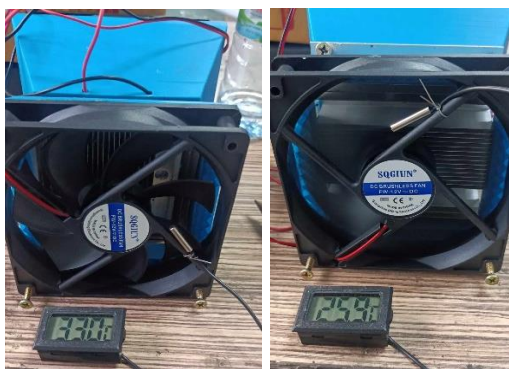
รูปที่ 8 ทดสอบวัดอุณหภูมิอากาศกับอุณหภูมิขณะทำงาน
