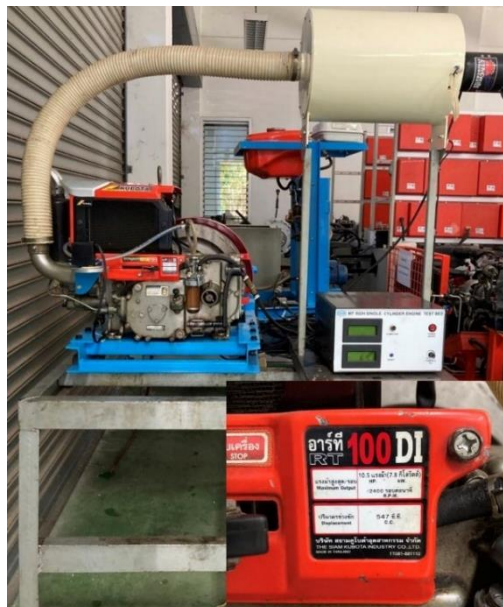
รูปที่ 5 ชุดทดสอบสมรรถนะของเครื่องยนต์ดีเซล แบบสูบเดียว [13]
