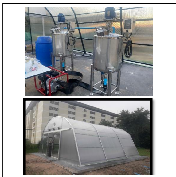
รูปที่ 2 ระบบการผลิตถังหมักก๊าซชีวภาพไร้อากาศแบบสองขั้นตอนให้ความร้อนด้วยพลังงานแสงอาทิตย์
