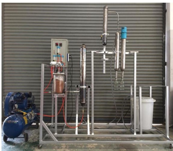
รูปที่ 2 หน่วยการผลิตแก๊สเชื้อเพลิงด้วยเครื่องปฏิกรณ์ฟลูอิดเบด
