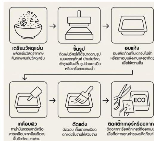
รูปที่ 5 แสดงกระบวนการผลิตวัสดุบรรจุภัณฑ์จากเศษเส้นกกเหลือทิ้ง
