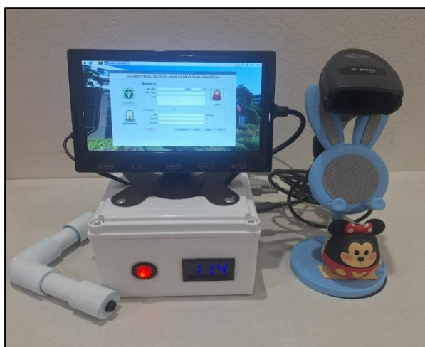
รูปที่ 3 เครื่องมือวัดสัญญาณชีพอัจฉริยะและยืนยันตัวตนผู้ป่วย
