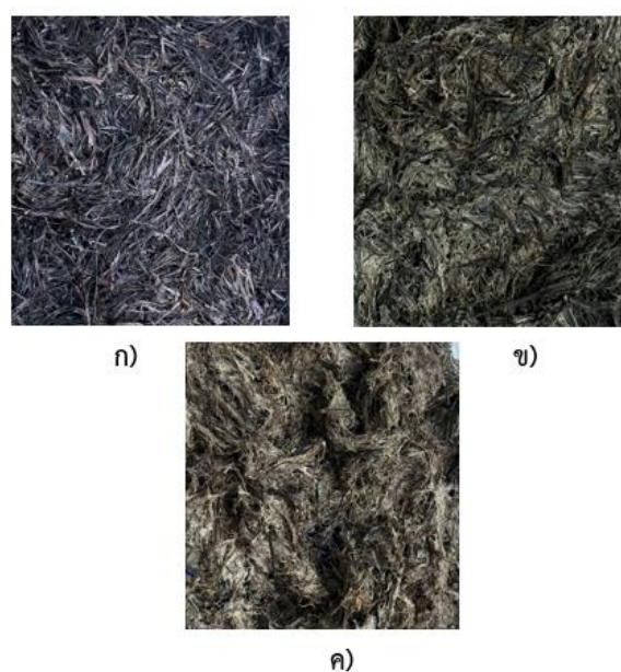
รูปที่ 2 เยื่อกกหลังจากแช่ด้วย NaOH ที่ความเข้มข้นแตกต่างกัน ก) 5% ข) 10% ค) 15%
