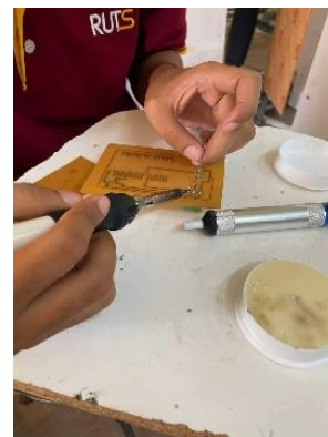
รูปที่ 17 การบัดกรีอุปกรณ์บนแผ่นวงจรพิมพ์
