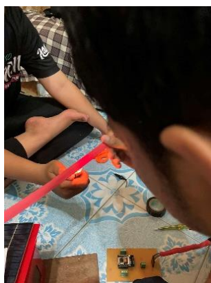
รูปที่ 19 การใช้ท่อหัดหุ้มสายไฟฟ้า
