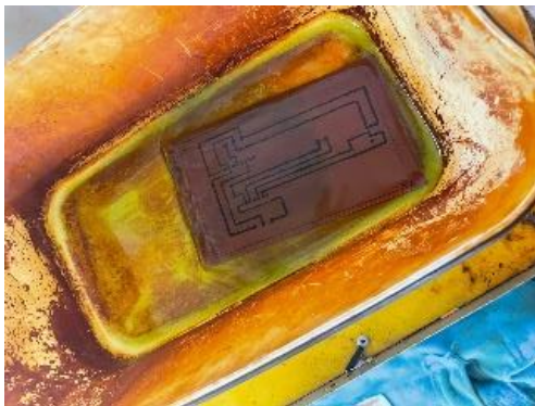
รูปที่ 14 การกัดแผ่นวงจรพิมพ์ด้วยเครื่องเขย่า อัลตราโซนิก
