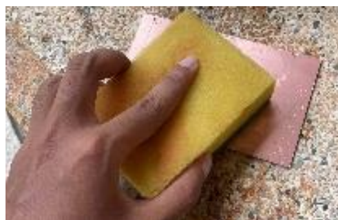
รูปที่ 12 การขัดผิวแผ่นทองแดง
