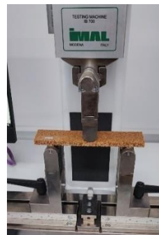
รูปที่ 6 ทดสอบความแข็งแรงในการดัดแบบสามจุด
