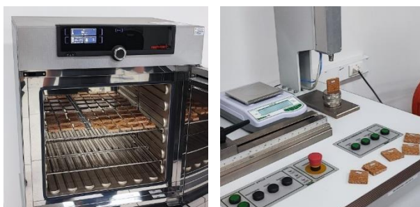
รูปที่ 5 การอบและวัดขนาดชิ้นทดสอบ
