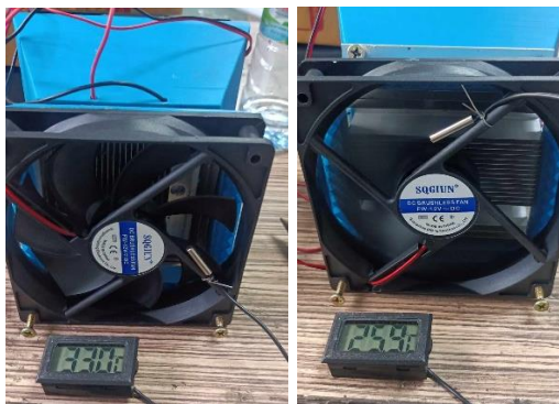
รูปที่ 8 ทดสอบวัดอุณหภูมิอากาศกับอุณหภูมิขณะทำงาน
