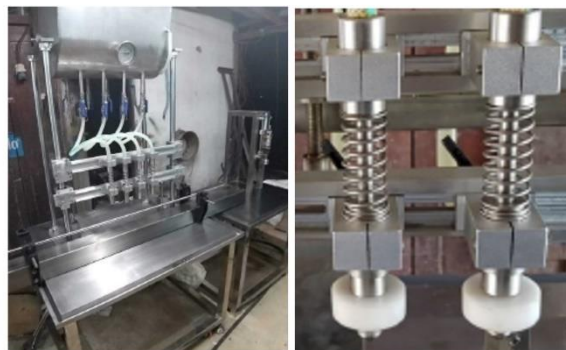
รูปที่ 3 การพัฒนาชิ้นโครงสร้างและระบบหัวจ่าย เพื่อให้สอดคล้องกับมาตรฐาน GMP
