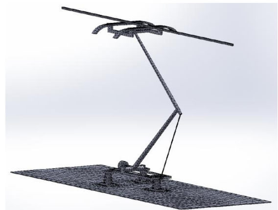
ค) การแบ่งเอลิเมนต์รูปทรงสี่หน้าและการเชื่อมต่อ ระหว่างเอลิเมนต์ภายในโครงสร้างแหวนรับไฟ
