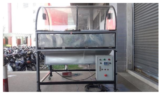
รูปที่ 4 เครื่องอบแห้งพลังงานแสงอาทิตย์แบบไฮบริด
