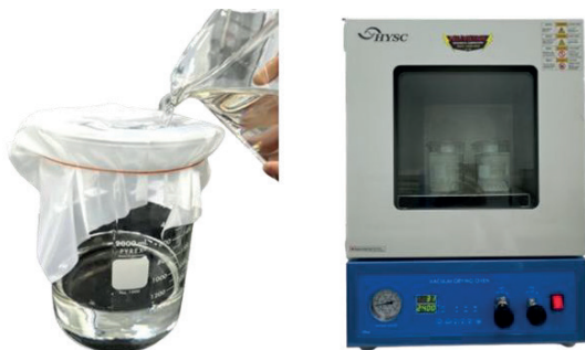
รูปที่ 2 การกำจัดสิ่งแปลกปลอมในน้ำมันหม้อแปลง และควบคุมความชื้น
