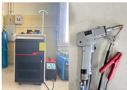
รูปที่ 1 เครื่องเชื่อมเลเซอร์รุ่น UG-1000LW Hand-held Fiber Laser Welding และหัวเชื่อม
