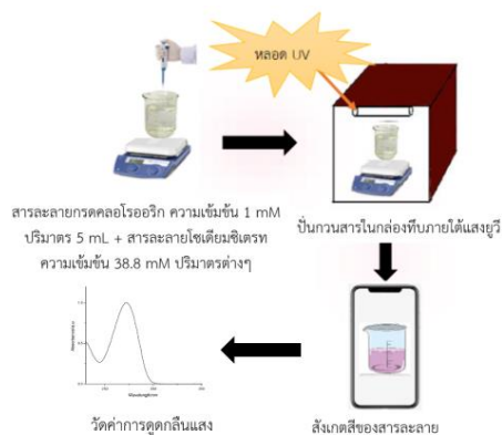
รูปที่ 1 ขั้นตอนการสังเคราะห์อนุภาคทองคำระดับนาโน
