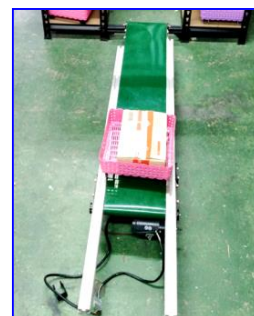
รูปที่ 8 การทดสอบความแม่นยำของคอนเวเยอร์
