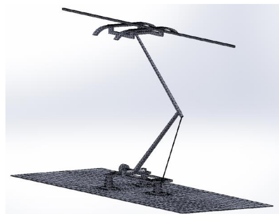
ค) การแบ่งอีลิเมนต์รูปทรงสี่หน้าและการเชื่อมต่อ ระหว่างอีลิเมนต์ภายในโครงสร้างแหวนรับไฟ
