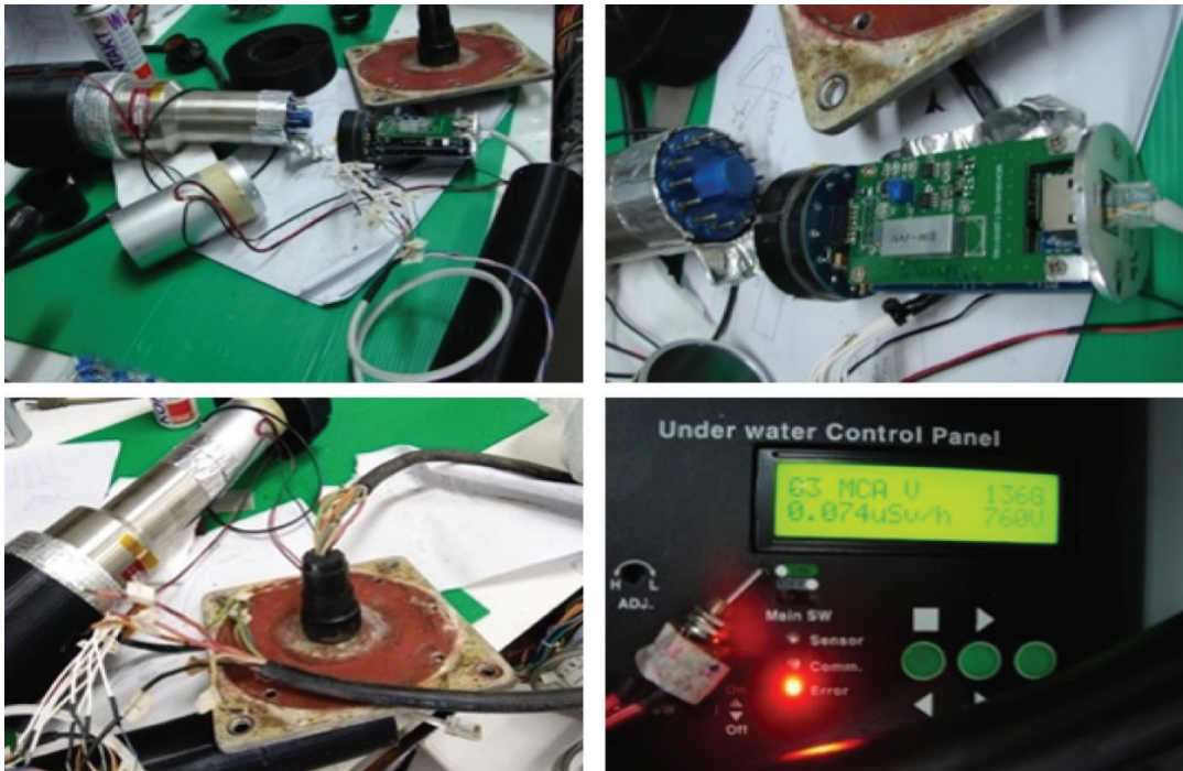
รูปที่ 8 การทดสอบการทำงานของระบบวัดรังสี
