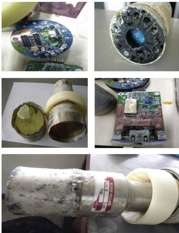
รูปที่ 4 ผลึกโซเดียมไอโอไดต์ หลอดโฟโตมัลติพลายเออร์ทิวบ์ และ Tube Base ของหัววัดรังสี NaI ที่ชำรุดเสียหาย (ต่อ)
