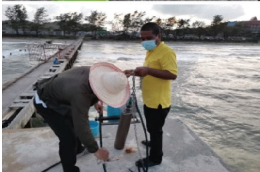
รูปที่ 11 การไหลดห้วยวัดรังสีโซเดียมไอโอไดต์ (NaI) ลงในอุปกรณ์ไหลดห้วยวัดรังสี
