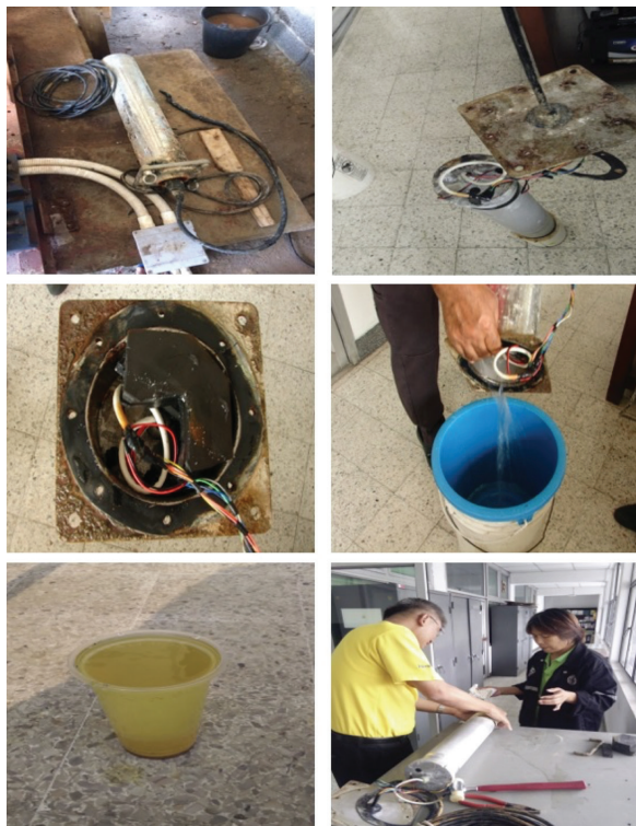
รูปที่ 3 สภาพความเสียหายของหัววัดรังสีโซเดียมไอโอไดต์ (NaI) เนื่องจากน้ำทะเล
