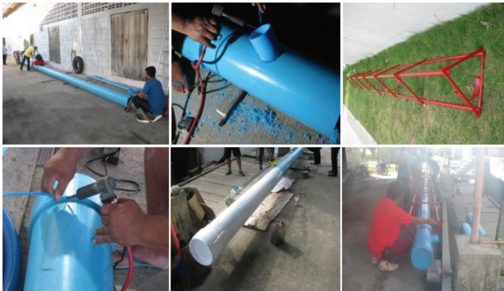
รูปที่ 6 การสร้างประกอบอุปกรณ์โพลดหั่ววัดรังสีได้น้ำทะเล
