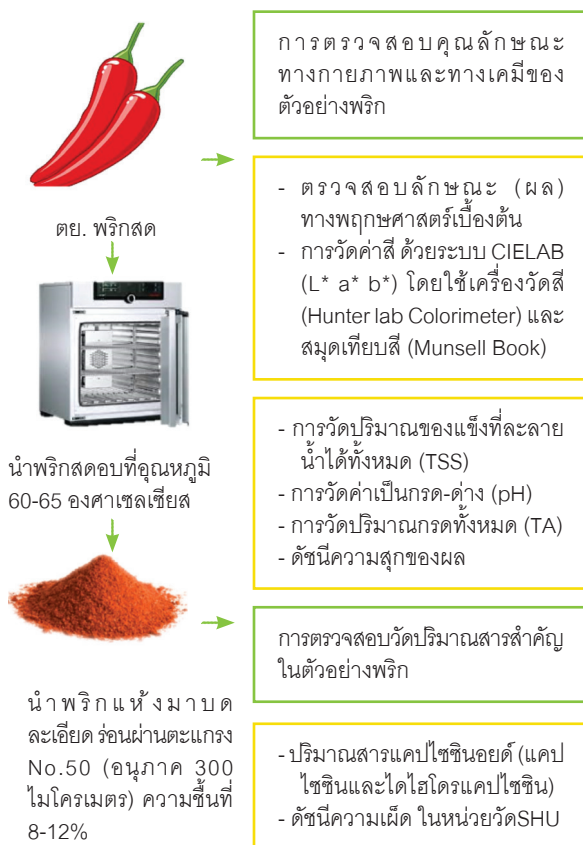
รูปที่ 1 ขั้นตอนการเตรียมตัวอย่างพริกสำหรับตรวจสอบคุณลักษณะทางกายภาพและทางเคมี
