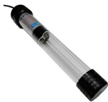
รูปที่ 3 หลอดผลิตรังสีอัลตราไวโอเลต ประเภทแรงดันไอปรอทต่ำ ขนาดกำลังไฟ 18 วัตต์
