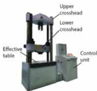
รูปที่ 1 องค์ประกอบเครื่องทดสอบแรงดึง/แรงกดชนิดสี่เสา
