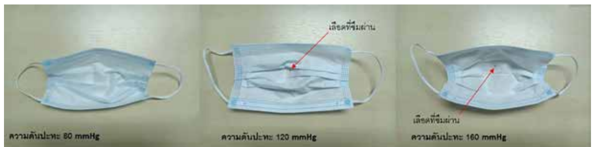
รูปที่ 9 ปรากฏการซึมผ่านของของเหลว (เลือดสังเคราะห์)
