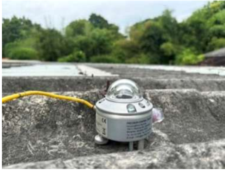
รูปที่ 2 หัววัดความเข้มรังสีอาทิตย์ (Pyranometer) ยี่ห้อ Kipp & Zonen รุ่น CMP22 ติดตั้งบนหลังคาระบบอบแห้ง
