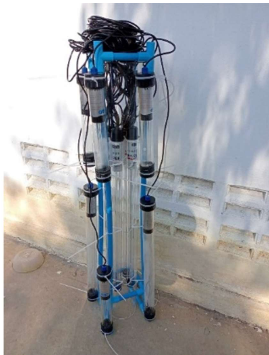
รูปที่ 2 แบบท่อรวมหลอดรังสีอัลตราไวโอเลต ระบบฆ่าเชื้อโรคในน้ำประปาหมู่บ้านด้วยรังสีอัลตราไวโอเลตแบบอัตโนมัติ
