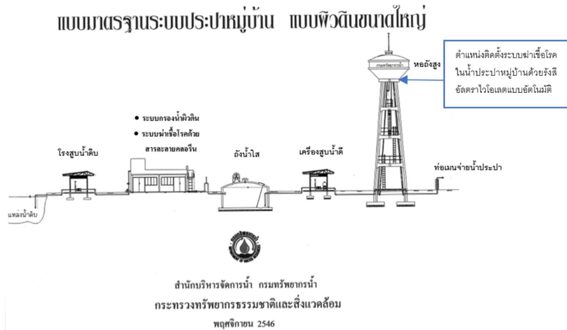
รูปที่ 3 ตำแหน่งติดตั้งระบบฆ่าเชื้อโรคในน้ำประปาหมู่บ้านด้วยรังสีอัลตราไวโอเลตแบบอัตโนมัติ
