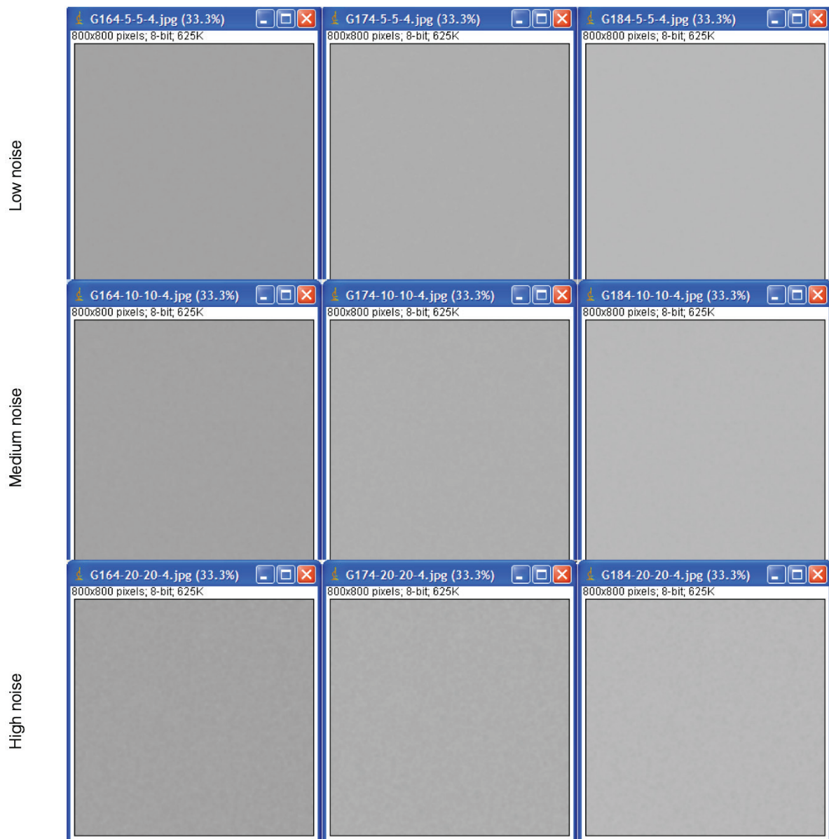
รูปที่ 2 ภาพสร้างจากคอมพิวเตอร์ (ชุดที่ 2) เพื่อให้เกิด Intensity variation (Noise) และ Mean gray value ในระดับที่แตกต่างกัน (Simulated image/Different variation (Noise)/Different mean gray level (Reflectance))
