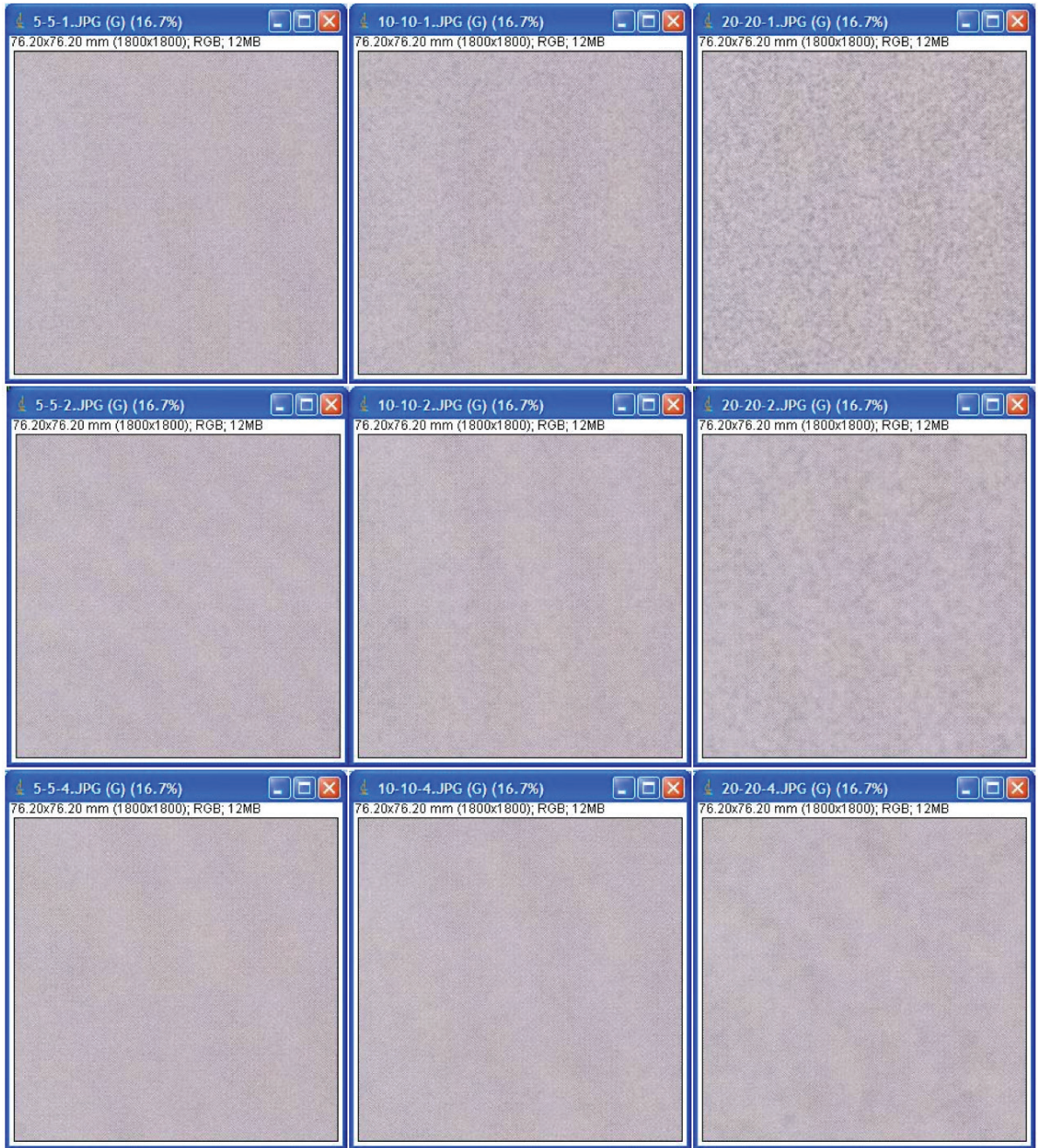
รูปที่ 1 ภาพสร้างจากคอมพิวเตอร์ (ชุดที่ 1) เพื่อให้เกิด Mottle ระดับที่แตกต่างกันอย่างชัดเจน (Simulated image/Different variation (Noise)/ Same mean gray level (Reflectance))
