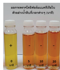
รูปที่ 7 ผลการตรวจโคลิฟอร์มแบคทีเรียด้วยชุดตรวจโคลิฟอร์มแบคทีเรีย อ.11 ของกรมอนามัย
