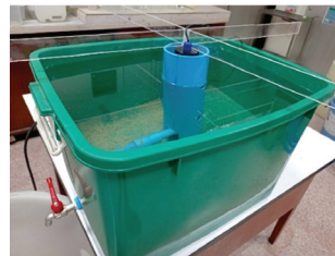
รูปที่ 4 ระบบฆ่าเชื้อโรคด้วยรังสีอัลตราไวโอเลต แบบอัตโนมัติ (ต้นแบบทดลองในห้องปฏิบัติการ)
