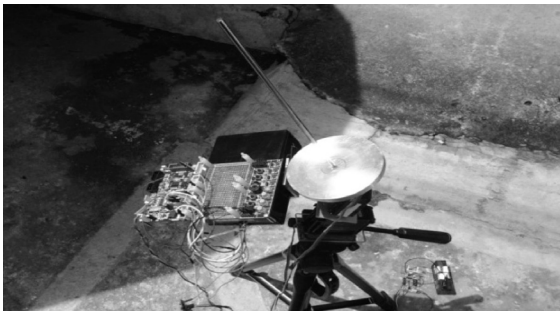
รูปที่ 1 แสดงเครื่องมือในการวัดมุมกวาดและมุมเงยตำแหน่งดวงอาทิตย์ เพื่อใช้ในการตรวจสอบความแม่นยำของสมการคำนวณตำแหน่งของดวงอาทิตย์ที่ใช้ในงานวิจัย (ก) คือ อุปกรณ์วัดดวงอาทิตย์ และ (ข) คือ แท่นวัดมุมกวาดและมุมเงย
