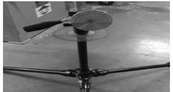
รูปที่ 1 แสดงเครื่องมือในการวัดมุมกวาดและมุมเงยตำแหน่งดวงอาทิตย์ เพื่อใช้ในการตรวจสอบความแม่นยำของสมการคำนวณตำแหน่งของดวงอาทิตย์ที่ใช้ในงานวิจัย (ก) คือ อุปกรณ์วัดดวงอาทิตย์ และ (ข) คือ แท่นวัดมุมกวาดและมุมเงย
