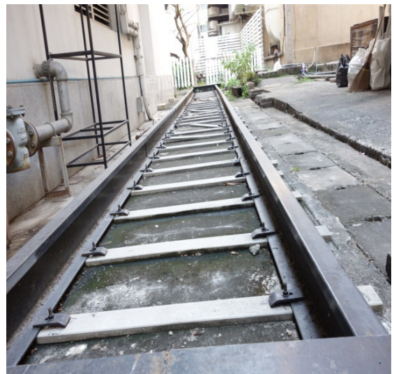
รูปที่ 5 : แสดงการทดสอบการทำงานจริงของระบบตรวจและบันทึกสภาพทางรถไฟสำหรับงานซ่อมบำรุงทางบนทางจำลองระยะทาง 18 เมตร
