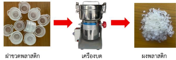
ภาพที่ 2 การเตรียมพอลิโพรพิลีนรีไซเคิล
