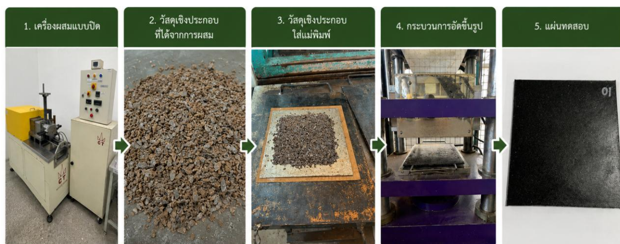
ภาพที่ 4 การผสมและขึ้นรูปวัสดุเชิงประกอบ
