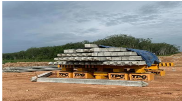
ภาพที่ 1 การทดสอบกำลังรับน้ำหนักของเสาเข็มในสนาม
