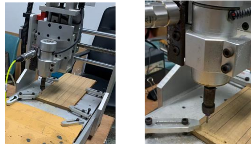
(ก) เครื่องซีเอ็นซีขนาดเล็ก (ข) บริเวณสปินเดิลและดอกกัด
