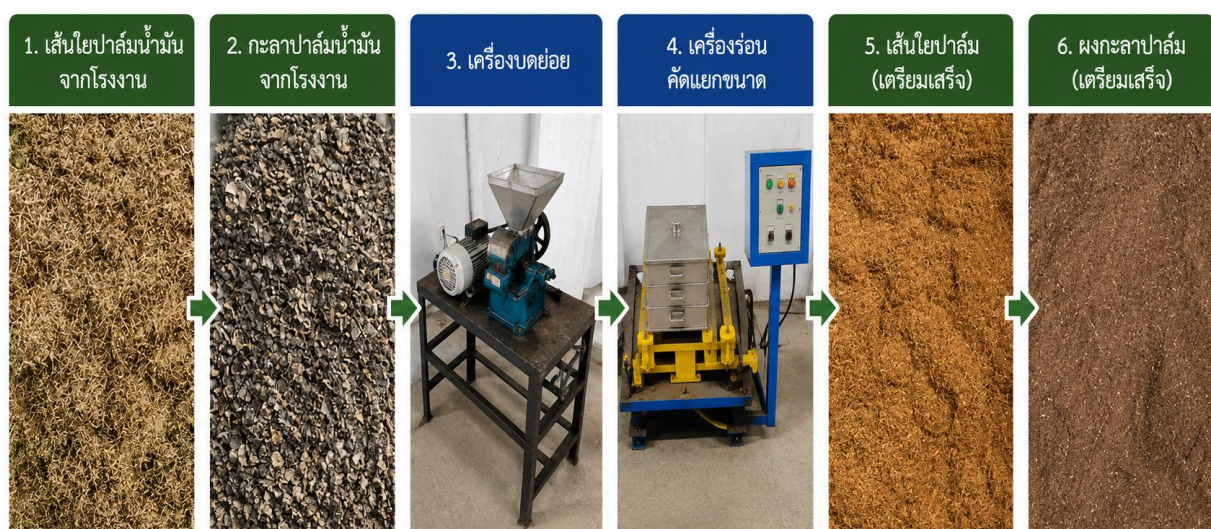
ภาพที่ 3 การเตรียมเส้นใยปาล์มน้ำมันและกะลาปาล์มน้ำมัน
