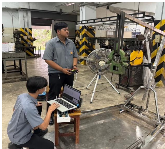
ภาพที่ 3 การทดสอบสมรรถนะเชิงโครงสร้างเบื้องต้น เครื่องช่วยพยุงเดิน และยกผู้ป่วยกึ่งอัตโนมัติ
