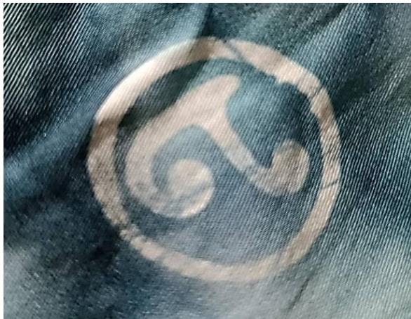
ภาพที่ 4 ตัวอย่างการพิมพ์ที่ละลายจากแม่พิมพ์ ABS
