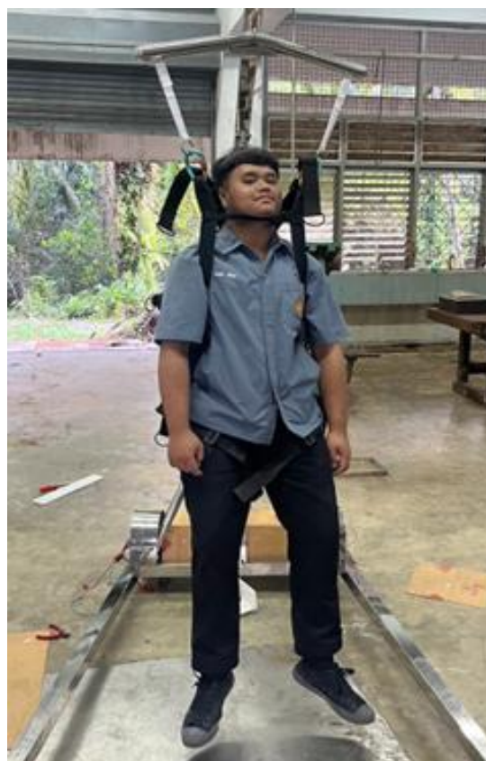
ภาพที่ 4 การทดสอบสมรรถนะการใช้งานจริงของเครื่องช่วยพยุงเดิน และยกผู้ป่วยกึ่งอัตโนมัติ
