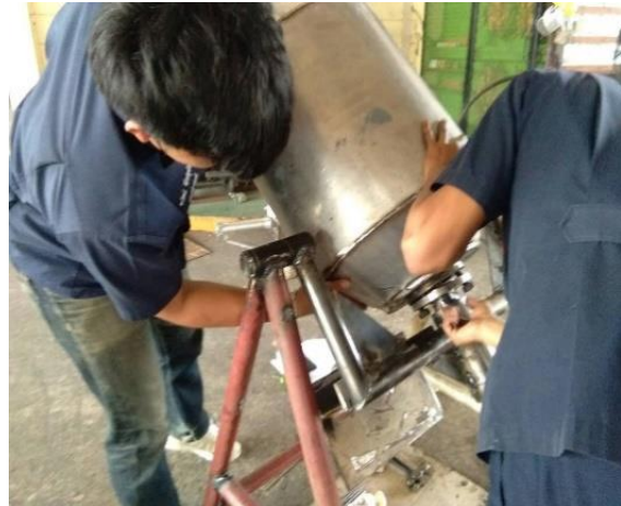
ภาพที่ 5 การประกอบตัวถังผสมเครื่องผสมปุ๋ย
