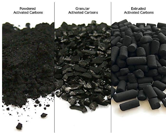
ภาพที่ 2 แสดงถ่านกัมมันต์ ชนิดผง ชนิดเกร็ด และชนิดอัดแท่ง
