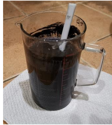
ภาพที่ 15 ผสมถ่านกัมมันต์ น้ำหนัก 100 กรัม กลีเซอริน 2 กรัม หัวน้ำหอม 1 กรัม กวนผสมให้เข้ากัน ตั้งพักไว้ประมาณ 3 นาที เพื่อลดปริมาณฟองอากาศก่อนเทลงแบบพิมพ์
