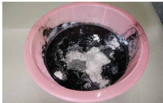
ภาพที่ 6 การผสมถ่านกัมมันต์กับน้ำกาวผสมให้ เข้ากันแล้วใส่ปูนปลาสเตอร์ที่เหลือ
