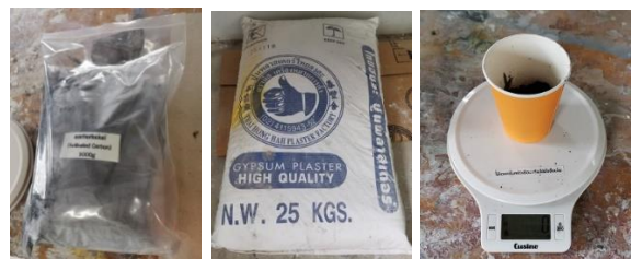
ภาพที่ 5 ถ่านกัมมันต์ ชนิดผง ปูนปลาสเตอร์ และเครื่องชั่งดิจิทัล
