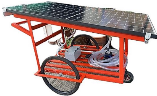
ภาพที่ 8 รถเข็นสูบน้ำแบบสองระบบโดยควบคุมจากระยะไกลผ่าน SONOFF
