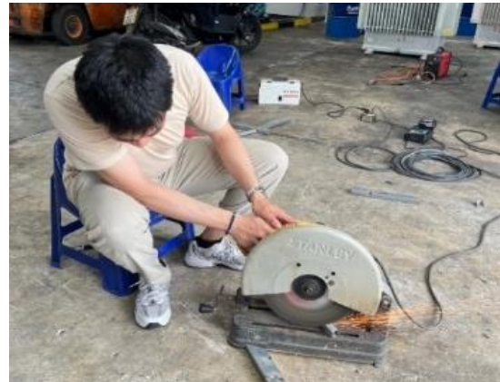
ภาพที่ 2 การตัดเชื่อมโครงรถเข็นสูบน้ำ
