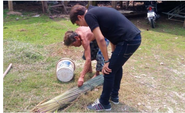
ภาพที่ 5 การหมักกระจุตด้วยโคลนเพื่อเพิ่มความเหนียวของกระจุต
