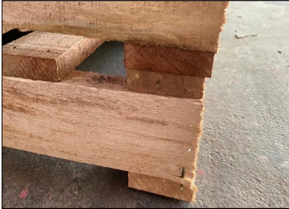
ภาพที่ 3 รูปแบบของเสียในการยิงตะปูติดเบี้ยว
