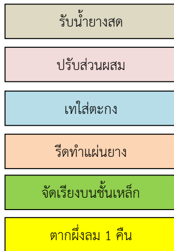
ภาพที่ 1 กระบวนการผลิตยางแผ่นดิบ ดัดแปลงจาก Thasanakula, P (2015) [6]
