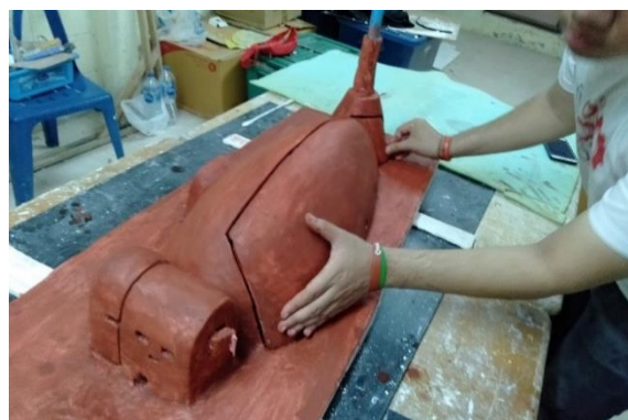
ภาพที่ 15 ต้นแบบ (Model) โครงสร้างแบบประกบเตาเผาไฟต่ำ
