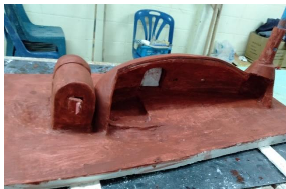
ภาพที่ 14 ต้นแบบ (Model) โครงสร้างเตาเผาไฟต่ำภายใน
