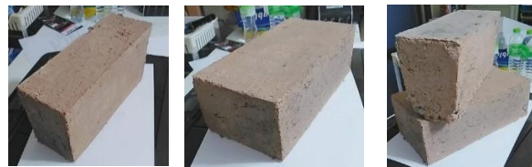
(1) อิฐก่อผนังเตาและก่อหลังคาเตา (2) อิฐหัวขวาน
