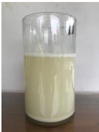
ภาพที่ 9 น้ำมันแยกชั้นจากน้ำกะทิที่ 12 ชั่วโมงวัดได้ ปริมาตร 2,064 ลูกบาศก์เซนติเมตร
