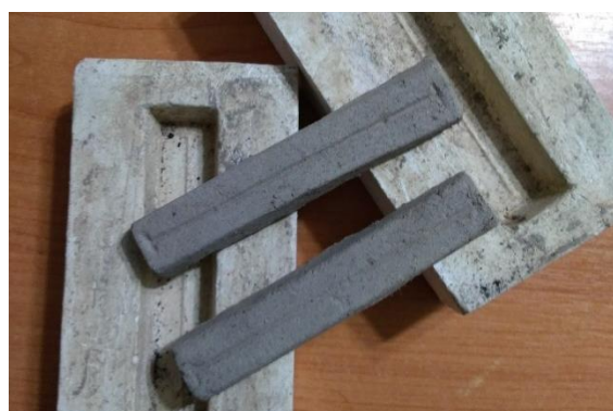
ภาพที่ 4 การขึ้นรูปแท่งทดสอบคุณสมบัติทางกายภาพ อัตราส่วนผสมของดินทนไฟ
