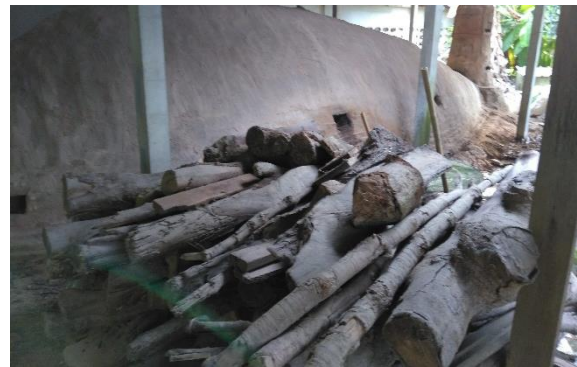
ภาพที่ 23 ปึกไม้ยางพาราที่เป็นเชื้อเพลิงในการเผา ผลิตภัณฑ์เตาเผาไฟต่ำ
