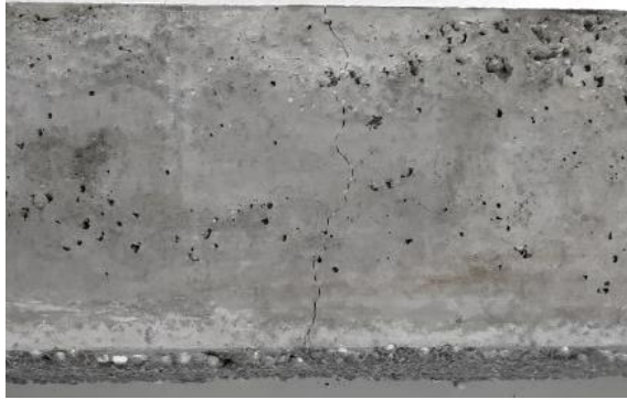
ภาพที่ 6 ลักษณะการพิบัติบริเวณท้องคานจากการทดสอบกำลังอัด
