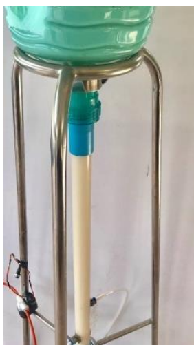
(ค) ถังหมักและการประกอบอุปกรณ์หมักและแยกน้ำมันมะพร้าว
