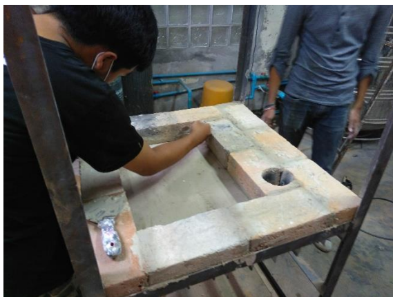
ภาพที่ 9 การใช้อิฐ C2 ชนิดก่อผนังนำมาก่อพื้นเตาเผา
