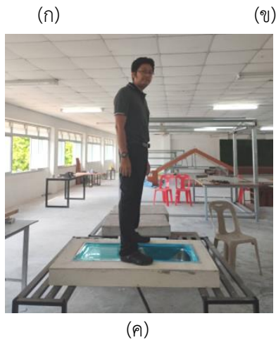
ภาพที่ 7 เคา์เตอร์ซิงค์ล้างจานจากโคมคอนกรีตเสริมไม้ไผ่
