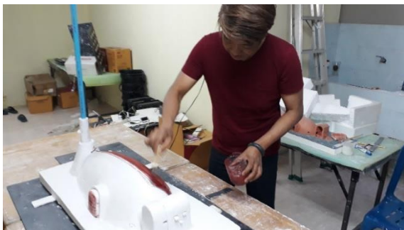
ภาพที่ 12 การสร้างต้นแบบ (Model) โครงสร้างของเตาเผาไฟต่ำเพื่อวิเคราะห์และประเมินความคิดเห็นโครงสร้าง
