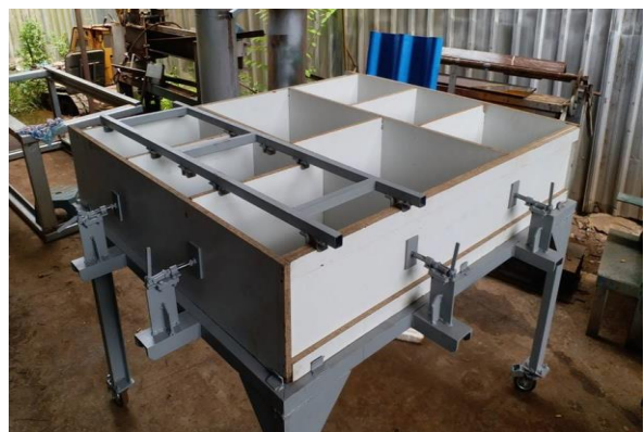
ภาพที่ 6 โครงสร้างของอุปกรณ์จับยึดสำหรับชุดชิ้นงานบน
