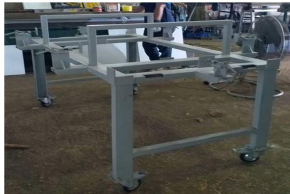
ภาพที่ 5 โครงสร้างของอุปกรณ์จับยึดสำหรับชุดชิ้นงานโค้งหน้า
