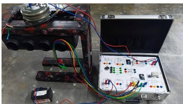
ภาพที่ 1 ชุดฝึกระบบไฟฟ้าปรับอากาศรถยนต์แบบโมดูลที่พัฒนาขึ้น
