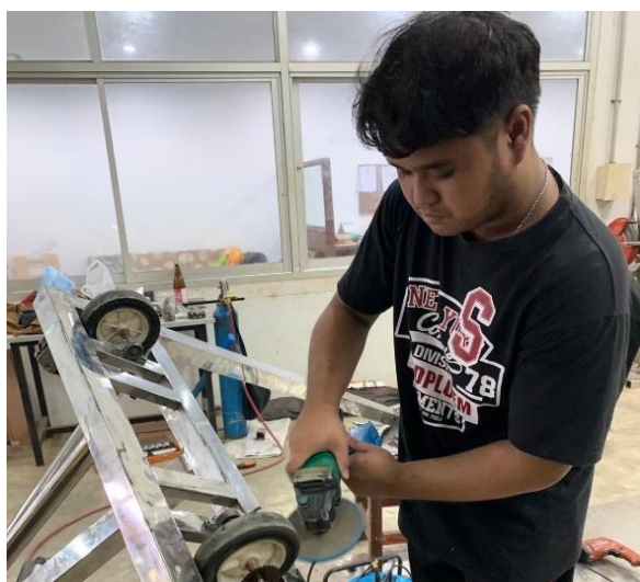
ภาพที่ 2 การสร้างและประกอบโครงสร้างเครื่องช่วยพยุงเดิน และยกผู้ป่วยกึ่งอัตโนมัติ
