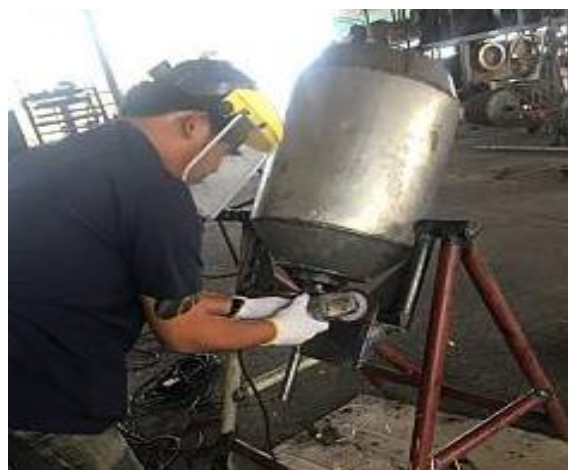
ภาพที่ 7 การปรับแต่งเครื่องผสมปุ๋ยภายหลังการทดสอบการใช้งาน
