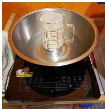
ภาพที่ 14 ให้ความร้อนด้วยเตาไฟฟ้า ใช้ความร้อน 120 องศาเซลเซียส (อุ่นผ่านความร้อน จากน้ำ)
