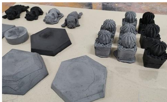
ภาพที่ 11 ต้นแบบผลิตภัณฑ์ที่ทดสอบอัตราส่วนผสมที่แตกต่างกัน
