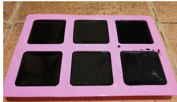
ภาพที่ 16 เทลงในแบบพิมพ์ซิลิโคน พักไว้ให้เย็นประมาณ 1 ชั่วโมง
